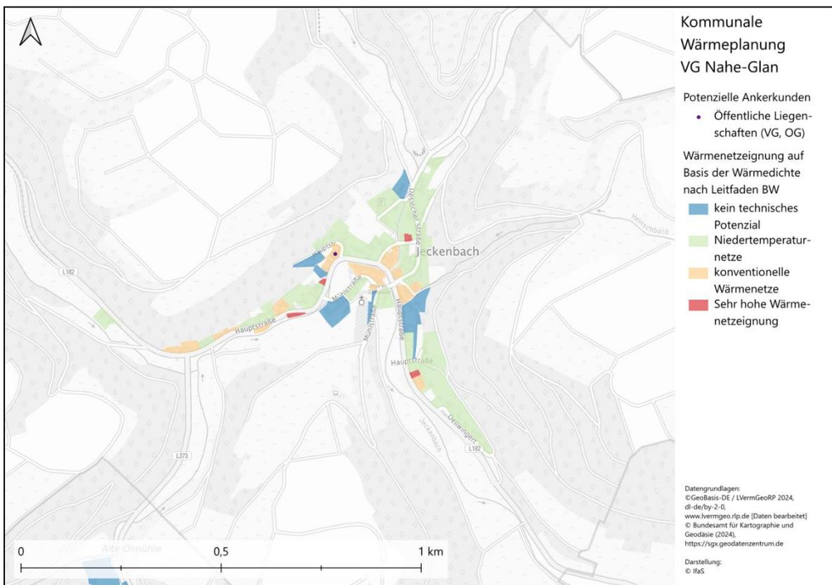
Abbildung 48: Wärmenetzbezeichnung
