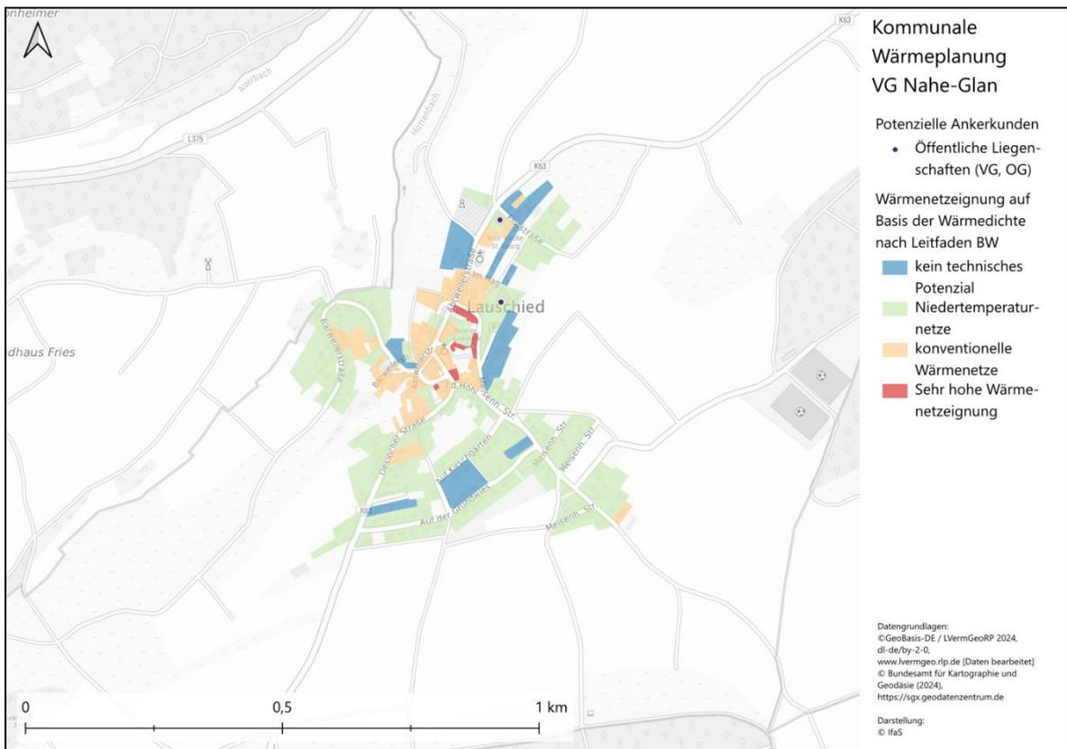
Abbildung 60: Wärmenetzzeignung
