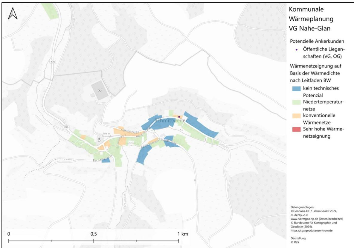
Abbildung 116: Wärmenetzzeignung
