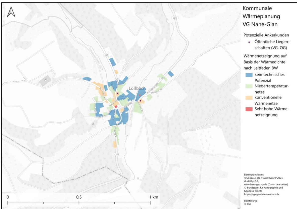
Abbildung 68: Wärmenetzzeignung
