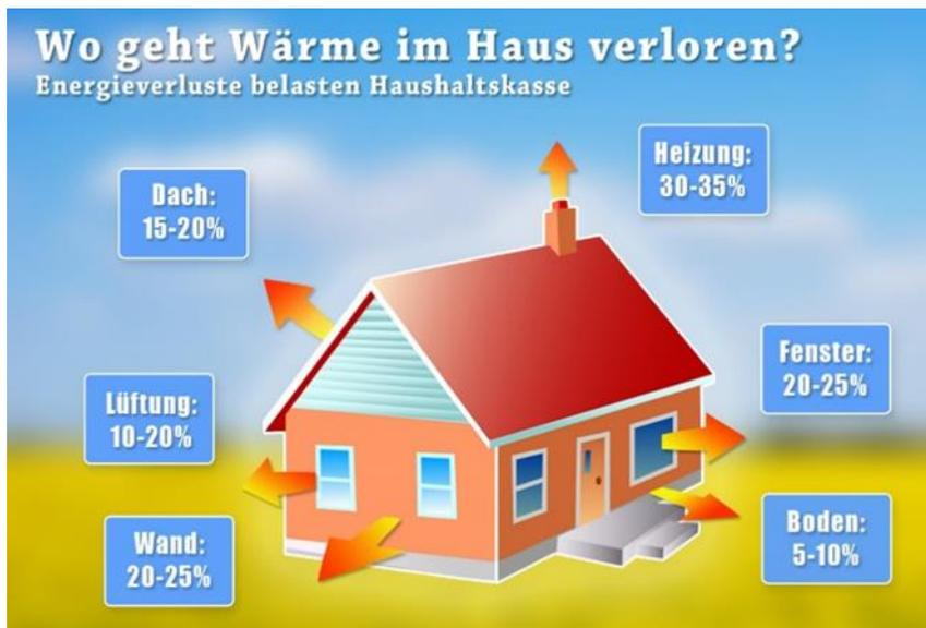
Abbildung 2-2: Energieverluste bei der Wärmeversorgung bestehender Wohngebäude<sup>11</sup>
