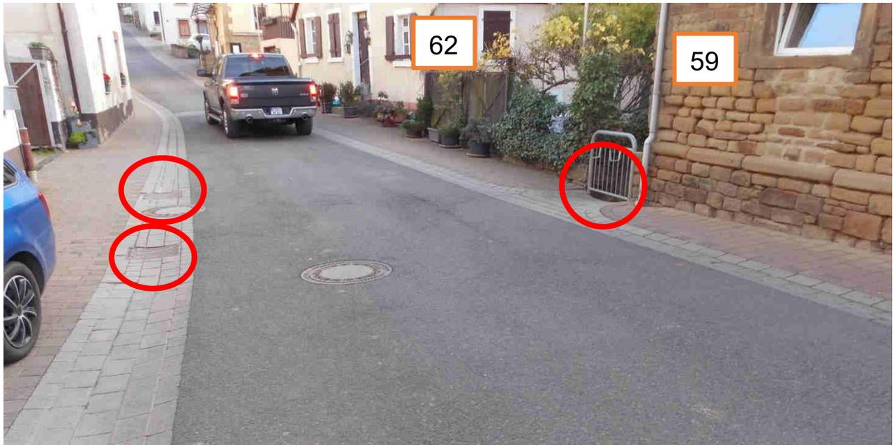
**Abbildung: Einläufe Bereich Tiefpunkt**
