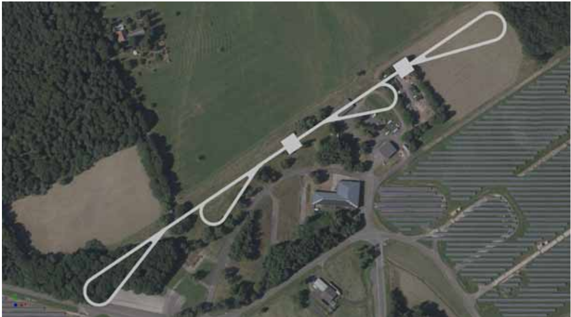
Abbildung 4: Optimierter Lageplan der Geräuschmessstrecke, Darstellung auf dem Luftbild (Stand 27.08.2021, Montage: SGS TÜV-Saar GmbH)
